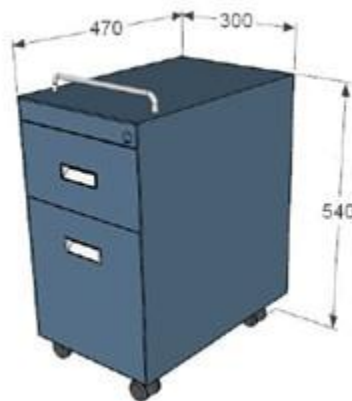
Figura 32 – Perspectiva cotada modelo item 30
