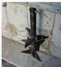
Figura 1. Dispositivo utilizado para os ensaios de desgaste
