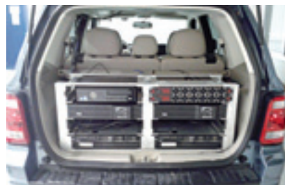
No porta-malas estão os computadores responsáveis pelo funcionamento do veículo
