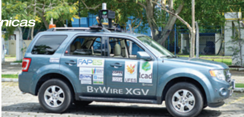
Carro autônomo desenvolvido pela UFES é guiado por um sistema de inteligência artificial
