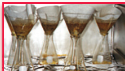
Béquer + funil: preparação das amostras de manteiga para verificação de contaminantes (materiais estranhos)
